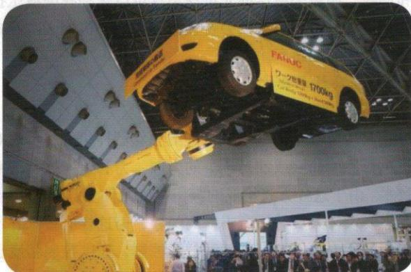
图1 FANUC 抓举汽车的大功率机器人
