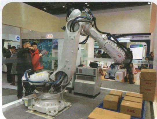
图2 ABB 的 200kg 载荷能力机械手
